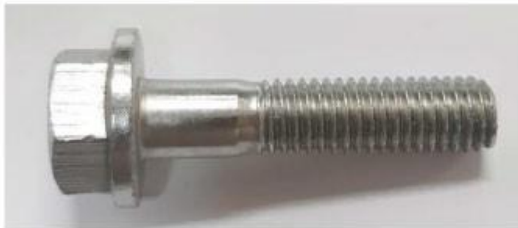
Bolt DIN 6921-10. 9 Hex flange bolt. Length 35
